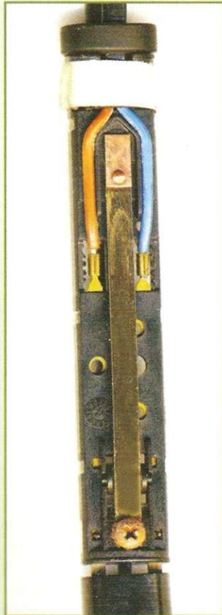
Биметаллическая пластина терморегулятора. В низкосортных изделиях этот элемент способен серьезно потрепать слух и нервы
