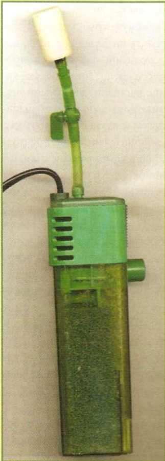
Такое оснащение инжектора внутреннего фильтра делает звук всасываемого воздуха мягче, не сказываясь на эффективности аэрации воды
