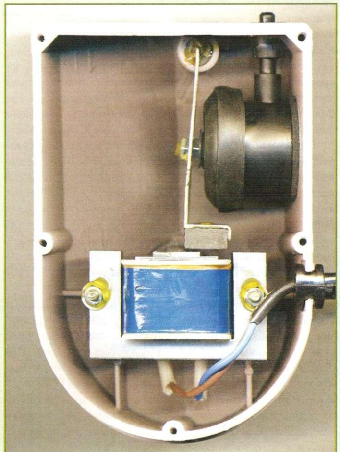
Биметаллическая пластина терморегулятора. В низкосортных изделиях этот элемент способен серьезно потрепать слух и нервы
