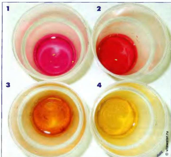
Интерпретация результатов тестов: 1 — вода с малым уровнем окисляемости; 2 — вода со средним уровнем окисляемости; 3 — вода с повышенным уровнем окисляемости; 4 — вода с высоким уровнем окисляемости.
