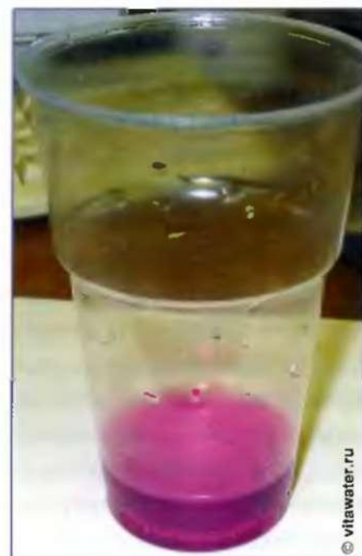
Пластиковый стаканчик с 50 мл тестируемой воды (после внесения капли концентрированного раствора марганцовки).
