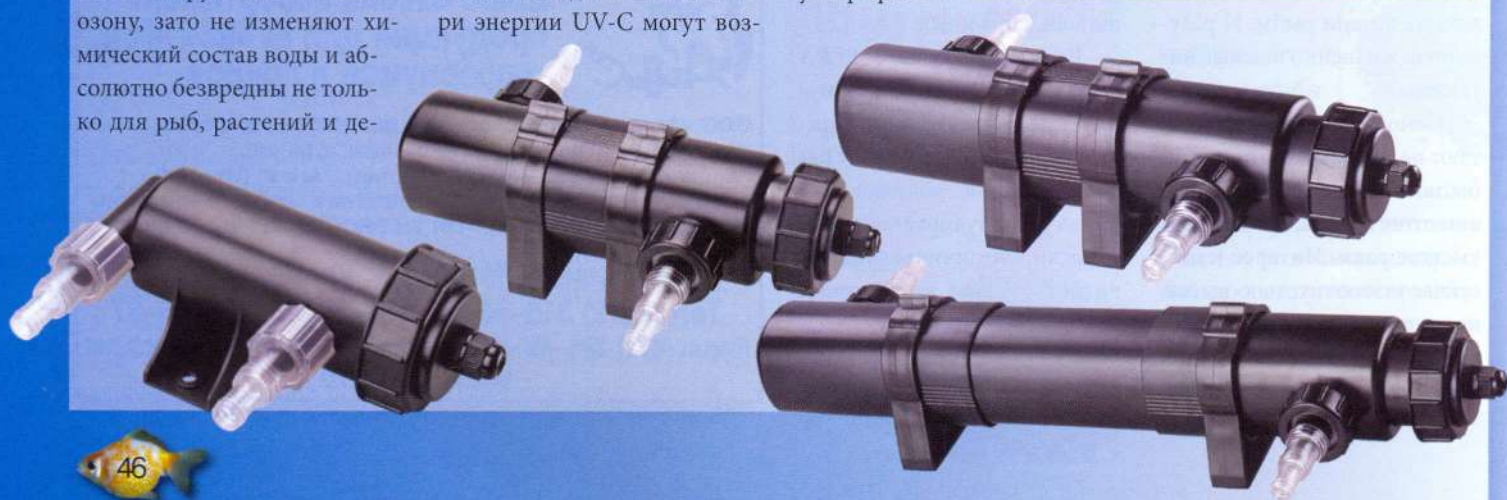
Кварцевая колба защищает УФ-лампу от воды, но свободно пропускает бактерицидные лучи диапазона UV-C. Излучение УФ-лампы убивает патогенные микроорганизмы. Очищенная вода возвращается в аквариум или пруд. Бактерии, грибки, водоросли, вирусы, «бродяжки», споры и пр. вместе с током воды заносятся в стерилизатор.
